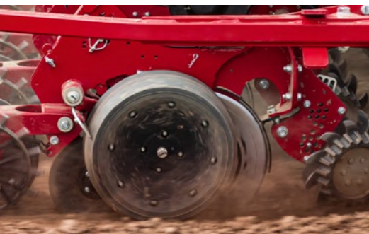
Тежки двойнодискови сеещи ботуши със слабоизносващи се, стабилни колела за водене в дълбочина
