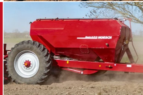
Бункерно ремарке с 2 000 литра за семена и 7 000 литра тор за Maestro 24 SV/SX и 36 SV
