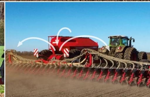
Използване теглото на бункера за генериране на допълнителен натиск и разтоварване на гумите
