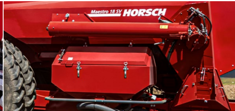
Зареждащ шнек и централна микрогранулатна уредба с 400 респ. 500 литра обем
