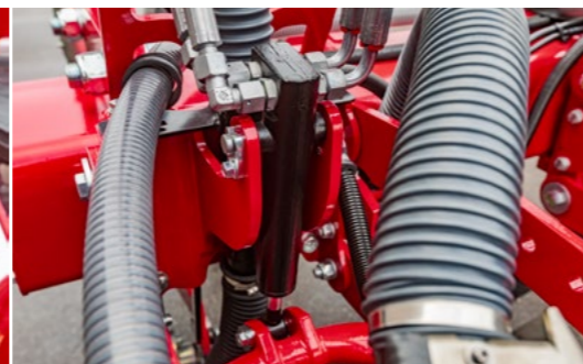
Стабилен монтаж на секциите и серийно вграден хидравличен цилиндър за генериране на натиск
