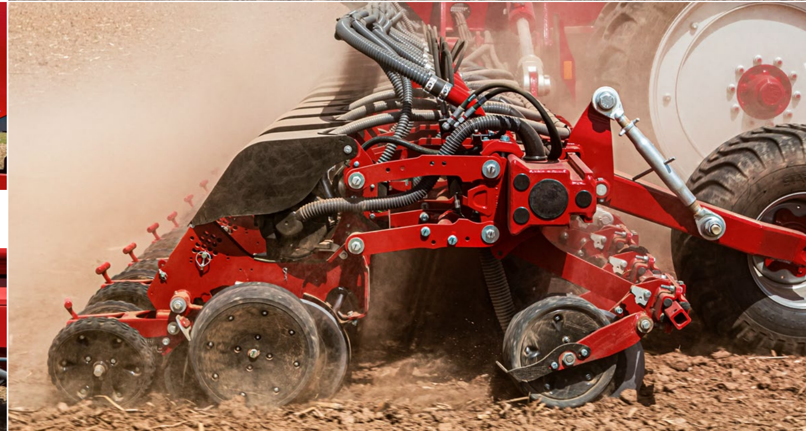
Еднодисков торвенящ ботуш със самостоятелно окачване и тежка и стабилна сееща секция на Maestro SV/SX с прецизно дозиране и система Main Tank Supply System (MTS)
