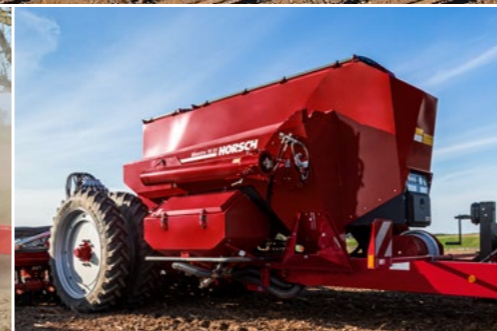
Бункерно ремарке с 2 000 литра за семена и 5 400 литра тор
